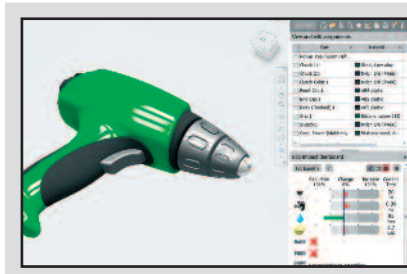
Med Autodesks nya Eco Materials Adviser är tanken att man ska kunna ta en assembly, definiera produktionsmaterialen och produktions sättet (om det är skuret eller formsprutat etc) och var någonstans arbetet utförs.
