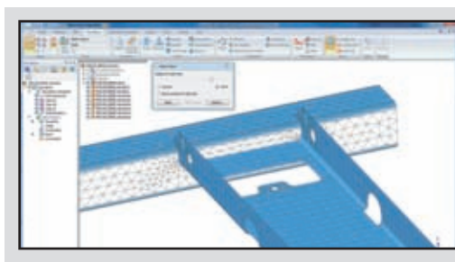
Tunnplåtskomponenter kan nu simuleras med hjälp av mer effektiva metoder, integrerade med Solid-mesh geometri.
